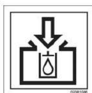
Umplere rezervor de ulei hidraulic
